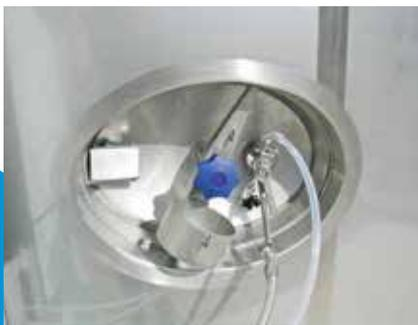
**Schneller Zugriff bei Bedarf:** Die Kontrollluke eröffnet den Blick in den Tankinnenraum. Optional lässt sich die Luke mit einer Probenentnahmeverrichtung ausstatten.
