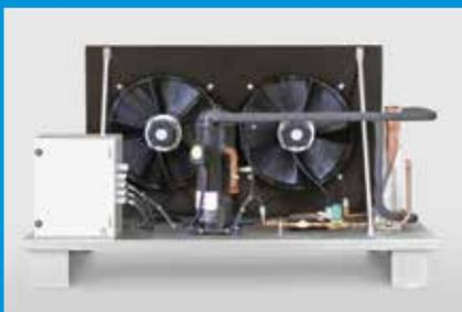
*Auf Energiesparen getrimmt: Scroll-Kompressor und hocheffiziente Ventilatoren lassen sich auf die zu erwartende Milchmenge abstimmen. Insgesamt sind 25 verschiedene Kälteaggregate mit einer Kälteleistung zwischen 3,82 – 30,7 kW/h bei einer Milchkühlleistung von 110 – 945 l/h verfügbar.*
